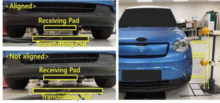
Şekil 5. SAE J2954'e göre maruz kalma değerlendirmesinin test kurulumu [10]
